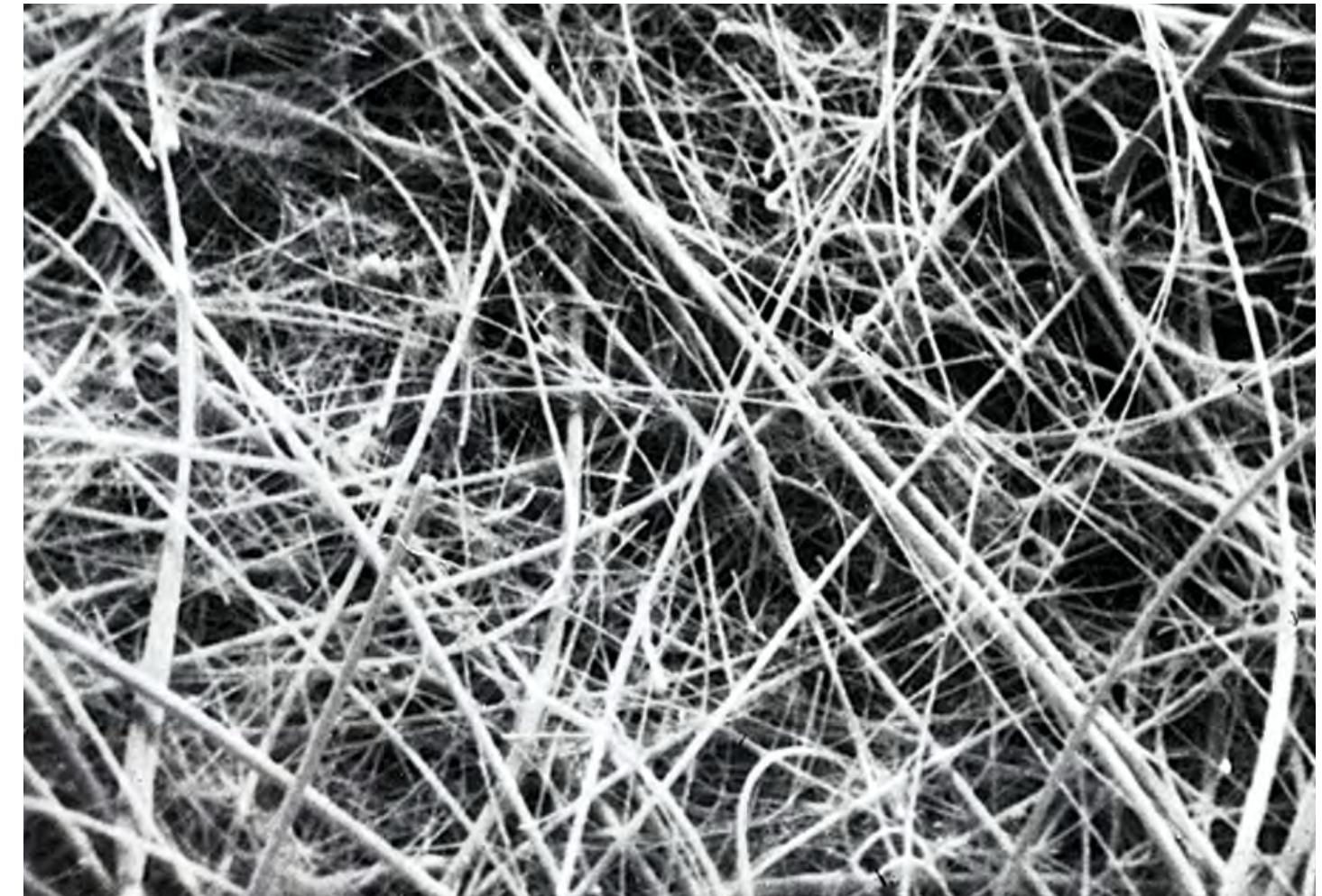
Filtry z mikrowłókien szklanych produkowane są w 100% ze szkła borokrzemowego.
